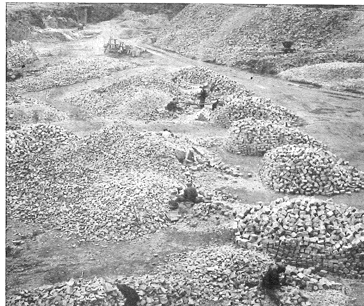
Fig. 32.—Fabricación de adoquines en las canteras de Caldas de Montbuy.
